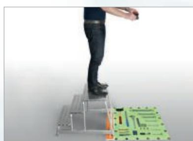
Быстрое внесение в eForm геометрии как единичного инструмента, так и сразу набора, с помощью специальной фотоподложки (при этом глубина фрезерования для всех объектов одинаковая).
