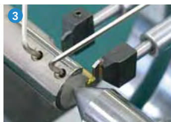
3. Отрегулируйте положение режущей пластины при помощи регулировочных винтов: ① Режущая часть: +0.015 \sim +0.020 мм ② Калибрующая часть: +0.005 \sim +0.010 мм ③ Обратный конус (разность между большим и меньшим радиусом): 0.010 \sim 0.015 мм
