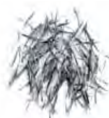
Глубина резания (Rd) = 1.0мм
