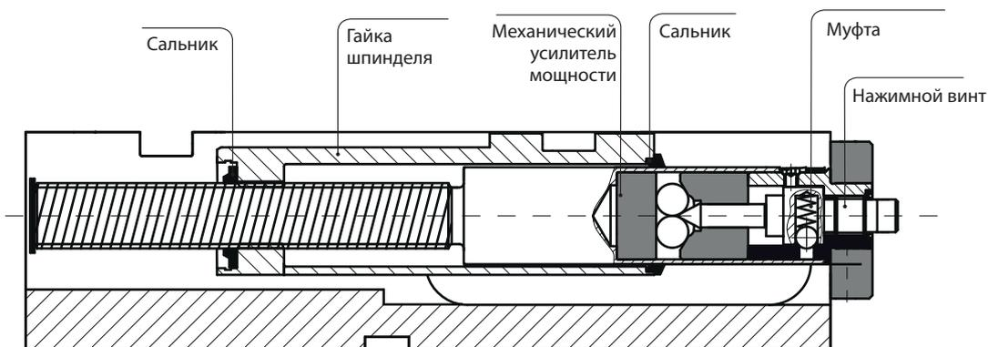
**formic** Тиски с механическим усилителем TITAN SC 125. Принадлежности
